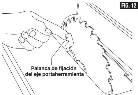
4. Mientras acopla la palanca de fijación del eje portaherramienta, afloje la tuerca del eje portaherramienta girándola en sentido contrario al de las agujas del reloj (hacia la parte delantera de la mesa de la sierra) con la llave de tuerca suministrada (Fig. 13).
