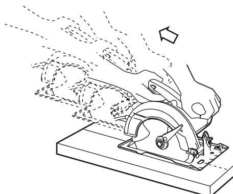
**No utilice la sierra con un ajuste de la profundidad de corte que sea excesivo.** Si una parte demasiado grande de la hoja queda al descubierto, se aumentan las posibilidades de que la hoja se tuerza en la sección de corte y se aumenta el área de superficie de la hoja disponible para causar un pellizco que produzca retroceso.
