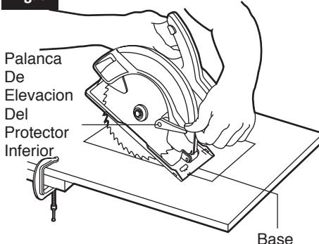
**ADVERTENCIA** Una vez que la placa-base descance en posición plana sobre la superficie que se esté cortando, libere el protector inferior y mueva la mano que sujetla la parte delantera de la placa-base para sujetar el mango auxiliar. Proceda a cortar en sentido hacia delante hasta el final del corte.
